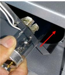
Insérez la nouvelle lampe en centrant la douille à l'autre extrémité de l'appareil
