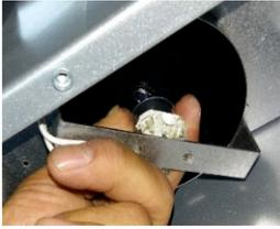
Tenez la lampe avec 2 doigts et faites-la pivoter jusqu'à ce que les broches d'alimentation soient visibles dans la douille
