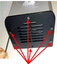
Retirez les 6 vis du couvercle supérieur avec une clé hexagonale N3
